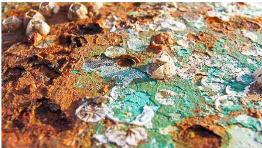
Fot. 7. Biokorożja metalu powodowana przez mikroorganizmy
